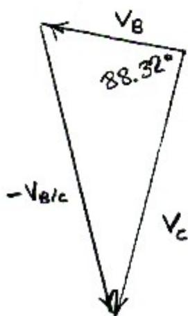
$$v_{B/C}^2 = v_B^2 + v_C^2 - 2v_B v_C \cos 88.32^\circ$$
